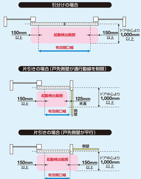
幅方向：起動検出範囲は、有効開口幅+左右各々**150mm以上**とする。
